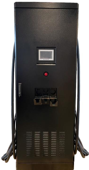
Зарядная станция электромобилей E-PROM 90 Standard предназначена для заряда электротранспорта постоянным током мощностью до 90 кВт с применением трёх видов разъемов (CCS Combo 2, CHAdeMO, GB/T), с динамической балансировкой мощности (*количество коннекторов может отличаться в зависимости от комплектации*). Зарядная станция имеет модульную конструкцию, которая позволяет обеспечить удобную эксплуатацию и сервисное обслуживание.
